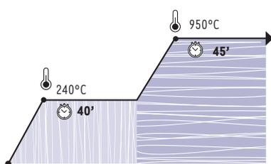
Si no se tienen en cuenta los tiempos y las temperaturas de secado indicadas pueden producirse grietas en la superficie de los cilindros, aunque esto no influya en la pieza colada.
