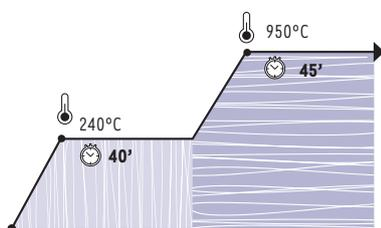
Se non si tiene conto dei tempi e delle temperature indicati per l'essiccamento, si possono avere crepe nella superficie dei cilindri, anche se ciò non influisce sulla fusione.
