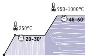
Si ces indications ne devaient pas être respectées, des fissures peuvent se produire à la surface des cylindres.
