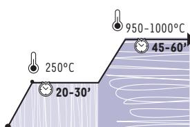
Si no se tienen en cuenta los tiempos y las temperaturas de secado indicadas pueden producirse grietas en la superficie de los cilindros, aunque esto no influya en la pieza colada.
