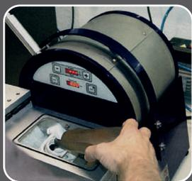
Insérez le creuset avec le matériau dans le tube en verre de quartz à l'intérieur de l'inducteur. Appuyez sur START (Démarrer).
