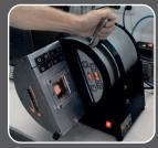
Eine viertel Umdrehung reicht aus, um den Guss in den Zylinder zu vollenden. Dank des Schauglases lässt sich der Fortschritt des Prozesses überwachen.
