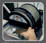
Den Tiegel mit dem Material in das Quarzglasrohr im Inneren des Induktors einsetzen. Auf START drücken.
