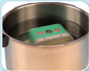
5. Polimerizzazione: Acqua a 45°C Pressione: 2 bar/30 minuti
