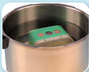
5. Polimerizado: Agua a 45°C Presión: 2 Bar /30 minutos
